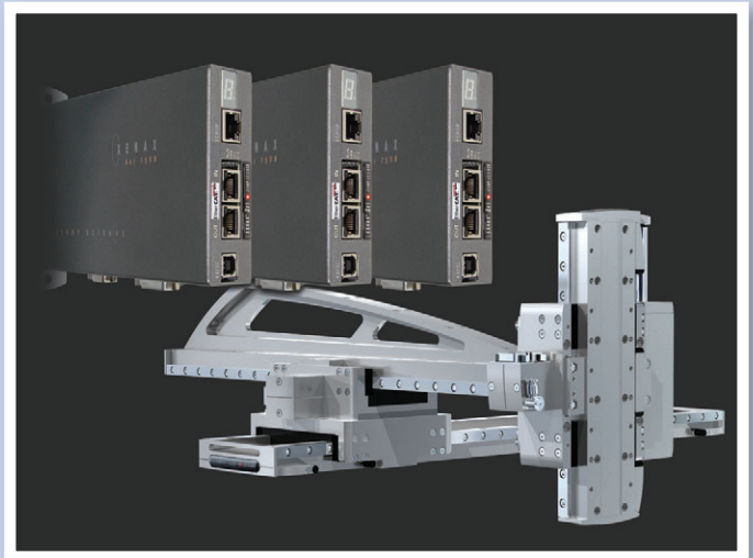
3-Achsen-Flächenausleger: Dank Master-/Slave-Funktion ist kein übergeordneter Positionscontroller nötig
